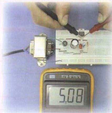
Figura 7.94. Midiendo el voltaje de salida del regulador fijo
